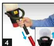
4 Insérer le Solo 330 dans la perche. Placer le Solo 330 sur le détecteur, en formant une étanchéité tout autour du bol.
